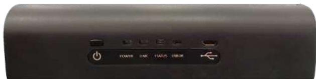
Рис. 2.7 Кнопка включения, индикаторы работы и разъем для зарядного устройства блоков ДФБ и ЭКГ
