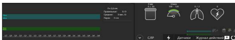
Рис. 7.16 Панель данных СЛР. Слева — показатели выполнения текущего цикла, справа — параметры цикла
