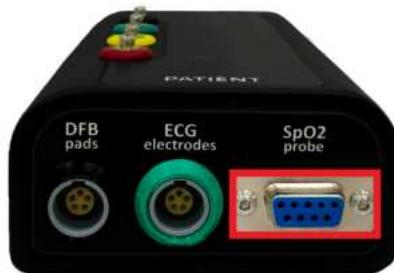
Рис. 2.14 Подключение пульсоксиметра
