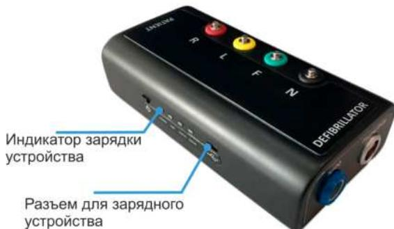
Рис. 1.5 Блок ДФБ/ЭКГ
