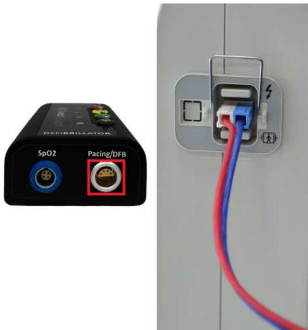
Рис. 2.10 Подключение дефибриллятора к блоку
