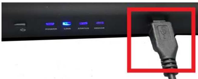
Рис. 1.6 Разъем подключения питания
